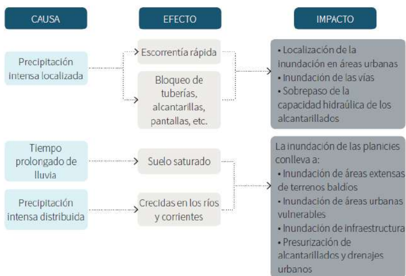
Figura 2. Causa efecto e impacto de precipitaciones localizadas y distribuidas. Tomado de CIACUA – CEDERI, 2006
